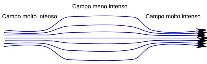
Fig. 6.1: schematizzazione del campo magnetico nella bottiglia magnetica.
